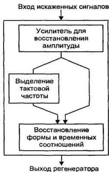
Рисунок 1.10. – Схема последовательности операции при регенерации оптического цифрового сигнала
