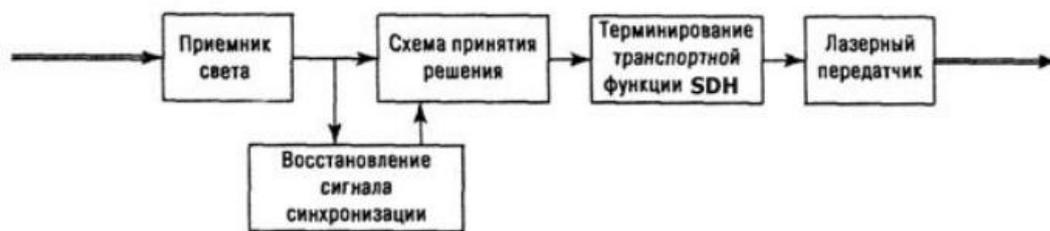
Рисунок 1.1 – Блок-схема упрощенного оптического регенератора
